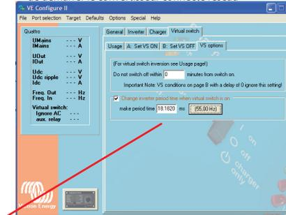
Définir la fréquence (normalement 55 hz) pour arrêter le convertisseur connecté réseau
