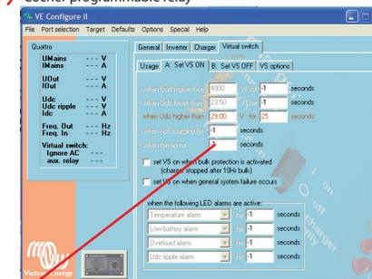
Définir la tension maximal de batterie afin d'arrêter le convertisseur connecté réseau
