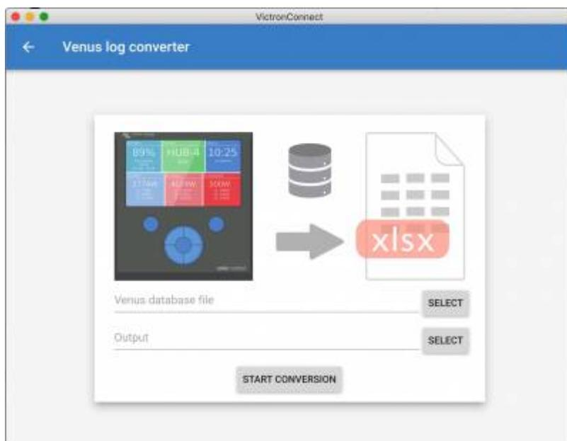
Pour récupérer ce fichier journal, vous devez disposer d'un dispositif GX ayant une clé USB ou une carte microSD installée, et le dispositif GX ne doit pas être connecté au VRM.
