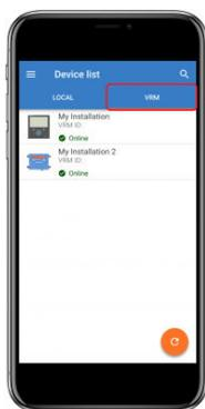
Lorsqu'une installation VRM est sélectionnée, il faut quelques secondes pour qu'une connexion soit établie. Une fois la connexion établie, deux onglets s'affichent, un onglet « OVERVIEW » (présentation générale) et un onglet « DEVICES » (périphériques).
