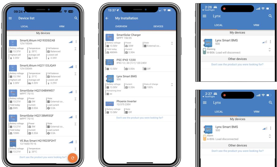
*Les données de Instant Readout sont transmises localement via Bluetooth (à gauche) et VE.Direct/VE.Can (au milieu) via VictronConnect-Remote. Cela comprend également les notifications d'avertissements, d'alarmes et d'erreurs (à droite).*
