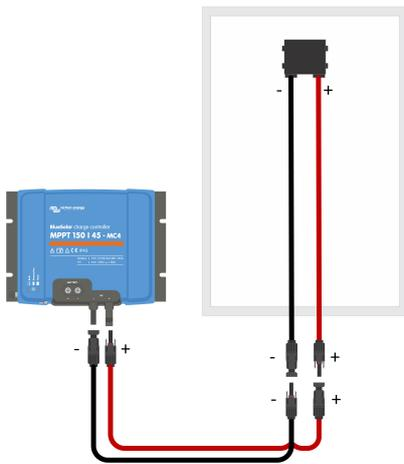
Chargeur solaire avec connecteurs MC4.
