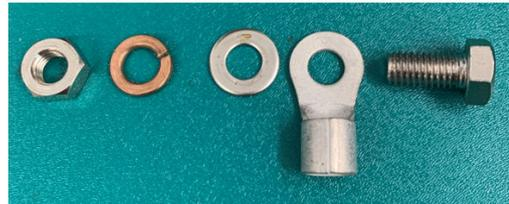
Utilisez des outils isolés pour serrer l'écrou. Un court-circuit accidentel de la batterie peut être très dangereux : l'électricité peut faire fondre une clé non isolée et une étincelle peut provoquer une explosion de la batterie.
