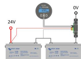
Dans un groupe de batteries en série/parallèle, il peut être utile de connecter les points médians de chaque chaîne de batteries connectées en parallèle puis en série. Cela permet d'éliminer le déséquilibre dans le parc de batteries.
