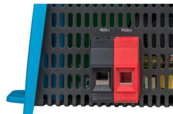
Dénudez une longueur suffisante de la gaine du câble avant d'insérer l'extrémité dénudée dans la cavité du connecteur. La gaine du câble ne doit pas pénétrer dans le connecteur. Cela pourrait entraîner une résistance trop importante. Le connecteur risque de chauffer et de fondre. Évitez que le câble nu soit visible à l'extérieur du connecteur. Cela peut provoquer une électrocution ou un court-circuit.
