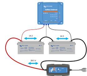
Si l'équilibrage de la batterie n'a pas l'effet souhaité et que la différence de tension dépasse 0,2 V, c'est que le déséquilibre entre les batteries est trop important pour être corrigé. Ce problème indique très probablement que l'une des batteries est défaillante. L'équilibreur de batterie émet alors un avertissement sonore et active son relais d'alarme.
