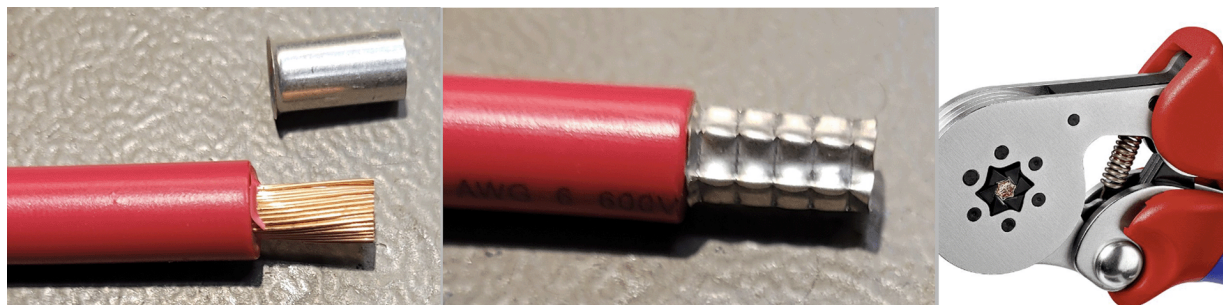
Embout à lacet à sertissage hexagonal
