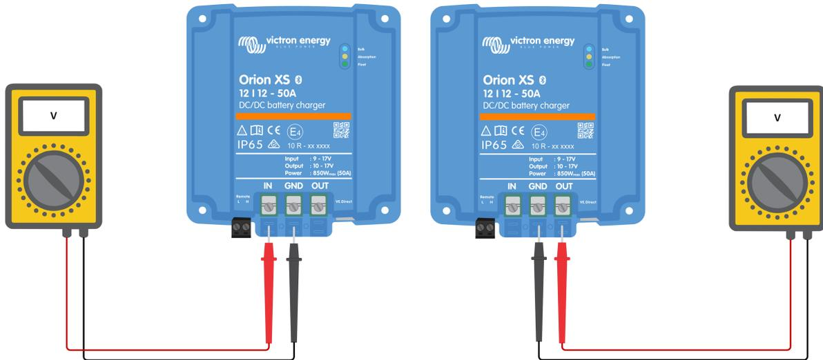
La raison pour laquelle la tension de la batterie est mesurée aux bornes du chargeur est que cela permet d'exclure d'éventuels problèmes de câblage, de fusibles et/ou de disjoncteurs sur le trajet entre la batterie et le chargeur.
