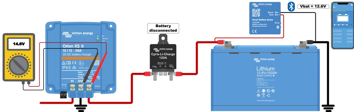
Bien que le fait que l'Orion XS délivre une tension plus élevée ne pose pas de problème, cela peut prêter à confusion lors de l'analyse des niveaux de tension dans un système et de leur comparaison avec les relevés du dispositif GX/de VictronConnect. Par conséquent, lors de l'analyse, assurez-vous que tous les branchements physiques nécessaires sont bien effectués.
