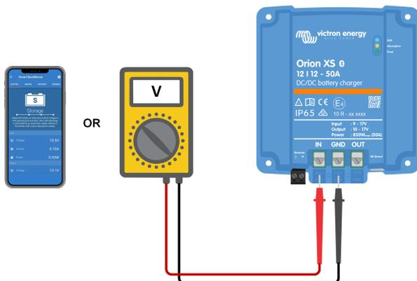
2. Mesurez la tension de la batterie aux bornes de la batterie à l'aide d'un multimètre.
