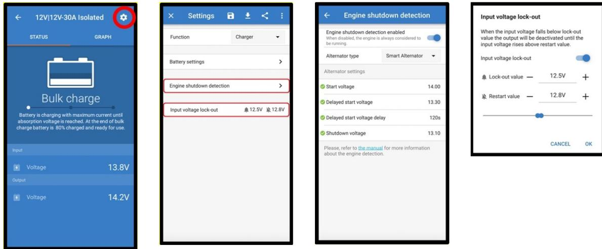
Illustration 9 : Menu de configuration de la détection de moteur à l'arrêt
