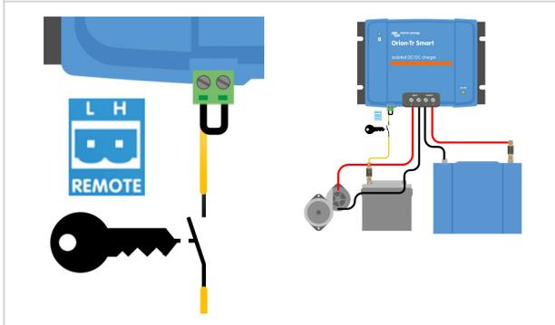
Permettre le processus de charge avec un interrupteur d'allumage et l'option d'allumage/arrêt à distance d)
