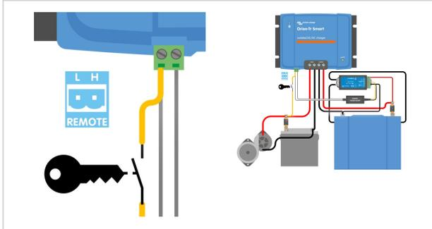
Illustration 4 : Diagramme de connexion pour ignorer la détection de moteur à l'arrêt
