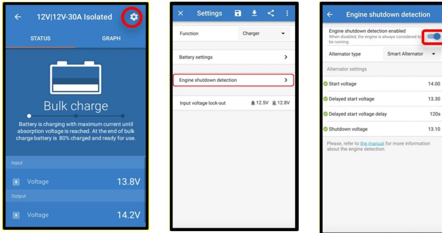
Illustration 5 : Désactiver la détection de moteur à l'arrêt
