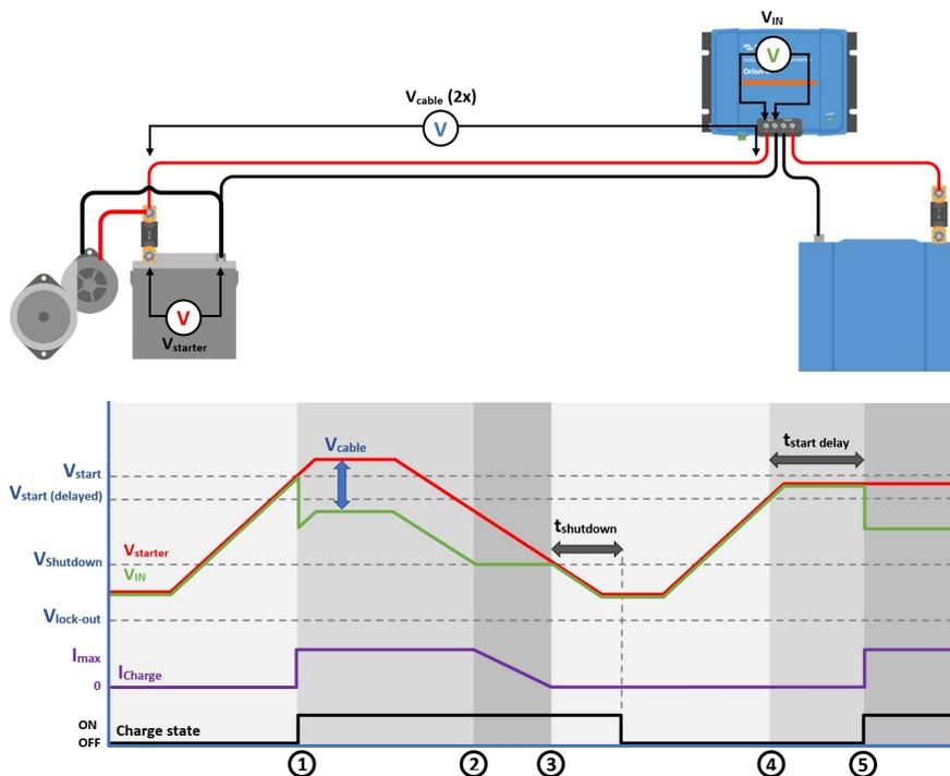
Illustration 8 : Séquence de détection de moteur à l'arrêt
