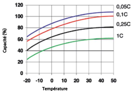
Fig. 1: de la température sur la capacité
