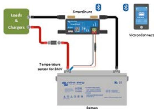
Mesure de la température de batterie
