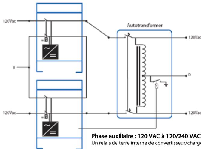
**Phase auxiliaire : 120 VAC à 120/240 VAC**
