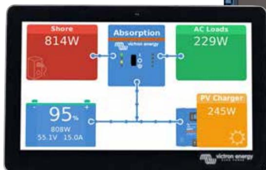
Cerbo GX : permet la surveillance à distance via le portail VRM, optimise les performances du système et démarre/arrête le générateur pour charger les batteries en cas de besoin. Son écran tactile GX donne une vue d'ensemble instantanée du système et permet aux installateurs de modifier les paramètres du système. Le système d'exploitation Venus permet de travailler avec Node-Red pour construire des flux automatisés détaillés basés sur n'importe quelle donnée.
