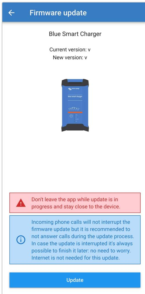
6. La mise à jour du micrologiciel commence et une barre de progression s'affiche sur la page de mise à jour du micrologiciel. Veillez à ce que l'appareil compatible Bluetooth (smartphone ou tablette) reste à proximité du **Blue Smart IP22 Charger** jusqu'à ce que la mise à jour du micrologiciel soit terminée et évitez d'utiliser l'appareil pendant cette période ; soyez patient car la mise à jour du micrologiciel peut prendre plusieurs minutes.
