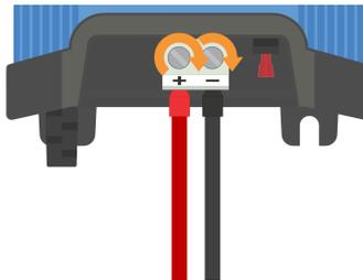
2. Installez un fusible en ligne ou un disjoncteur de calibre approprié dans le câblage d'alimentation CC entre le **Blue Smart IP22 Charger** et la ou les batteries, aussi près que possible des batteries ; reportez-vous à la section « Installation > Câblage > Protection contre les surintensités » pour plus d'informations.
