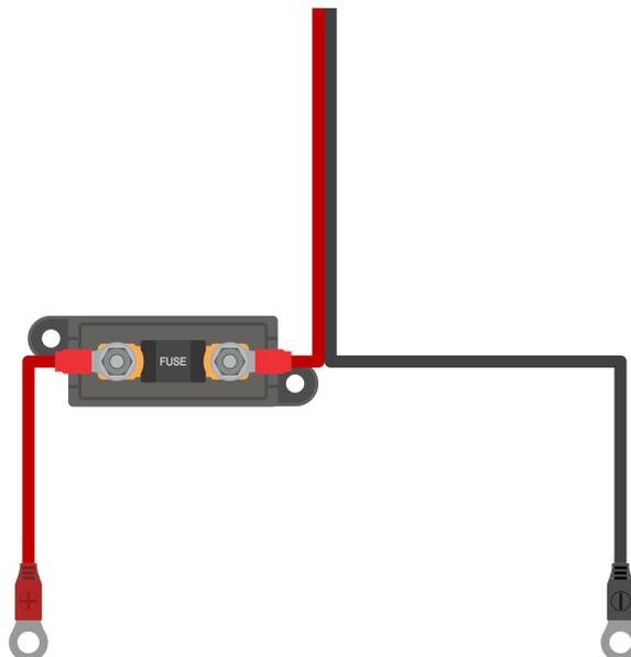
3. Branchez le câble d'alimentation CC à la batterie/aux batteries ou au bus de distribution du système CC - suivez les instructions correspondant au type d'installation.
