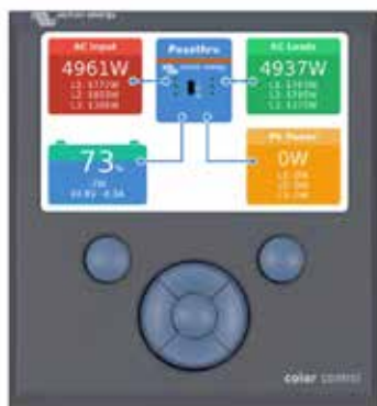
Color Control GX, montrant une application PV
