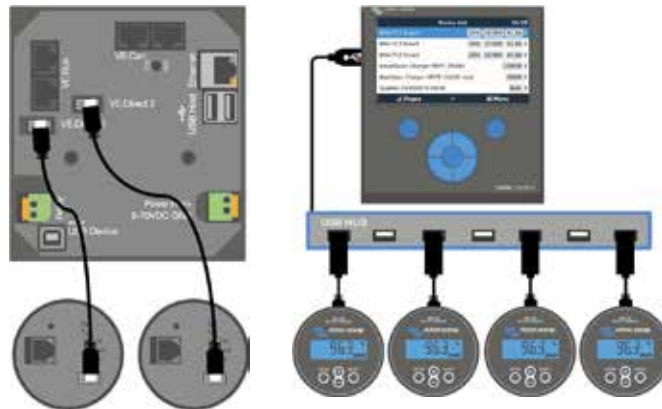
Au maximum, quatre BMV peuvent être connectés directement au Color Control. Davantage de BMV peuvent être connectés à un Hub USB pour un contrôle central.
