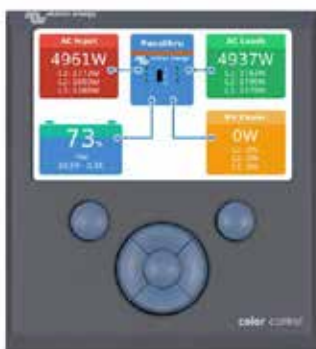
Color Control GX, montrant une application PV
